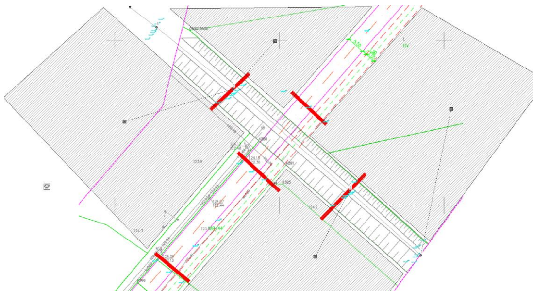
Rys. 9. Schemat modelu hydraulicznego przepływ swobodny - bez mostu .
